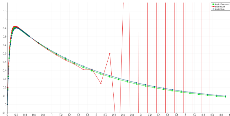
Рис. 3: Решение жесткой задачи разными методами с ограничением шага в погранслое (красный — не A-устойчивый явный метод Эйлера, зеленый — A-, но не L-устойчивый неявный метод средней точки, синий — A- и L-устойчивый неявный метод Эйлера)
